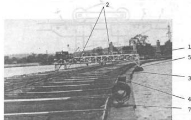
Рис. 20. Устройство для раздачи комбикормов в садках: 1 — кормораздатчик; 2 — бункер для кормов; 3 — направляющее колесо движущего устройства; 4 — дорожка деревянная для движущего колеса; 5 — поплавки; 6 — садки
